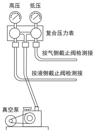
**3** 把软管与真空泵接头连接。此时室外机的操作阀完全关闭。
