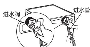
注意：1.安装完毕后，打开水龙头，检查是否漏水。
