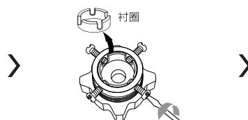
旋松四颗螺钉，将连接座套
