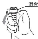
下压滑套，将进水管
