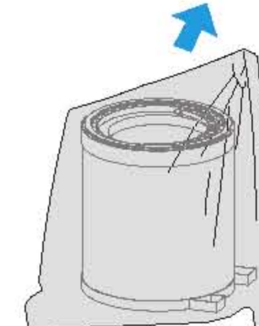
更换新的滤网组件
