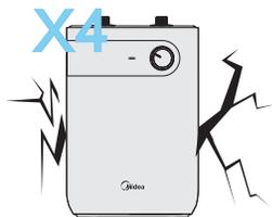
❗ 墙壁需承受电热水器注满水后四倍以上的重量才可安装，否则采取其他加强措施
