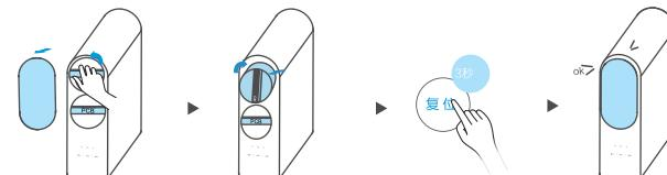
打开前盖，向外拔出滤芯盖；旋转滤芯把手，旋出滤芯并取出
