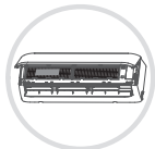
抓住面板两端稍用力向外拉， 打开约75度角
