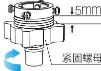
1. 旋松紧固螺母，使螺纹露出约5毫米。
