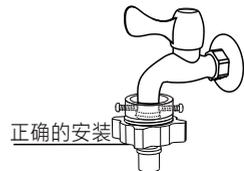
注：不要直接在洗衣机专用水龙头的转接头上安装连接座。如果用户已有洗衣机专用水龙头，为防止脱落漏水，请拧下转接头后，再按照下一页中正确的方式连接进水管与水龙头。
