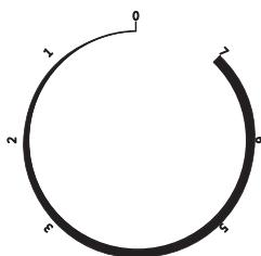
酒柜内的温度是通过温控旋钮来调节的。控制板上面“1, 2, 3, 4, 5, 6, 7”不代表具体的温度，数字越小，柜内温度越高，数字越大，柜内温度越低。“0”表示停机档。
