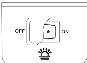
酒柜箱内照明灯可通过开关来调节，ON表示照明灯开启，OFF表示照明灯关闭。
