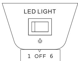
酒柜内的温度是通过温控旋钮来调节的。控制板上面“1, 2, 3, 4, 5, 6, OFF”不代表具体的温度，数字越小，柜内温度越高，数字越大，柜内温度越低。“OFF”表示停机档。照明灯可通过灯开关进行调节。
