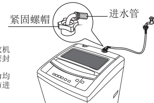
将进水管的另一端旋紧在洗衣机进水阀接头上。（内有橡胶密封垫圈）
