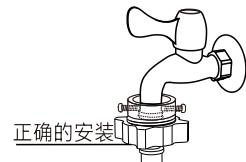
注：不要直接在洗衣机专用水龙头的转接头上安装连接座。如果用户已有洗衣机专用水龙头，为防止脱落漏水，请拧下转接头后，再按照下一页中正确的方式连接进水管与水龙头。
