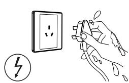
请勿用湿手插拔电源线插头,以防触电。
