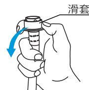
5. 下压滑套，将进水管插入连接座。
