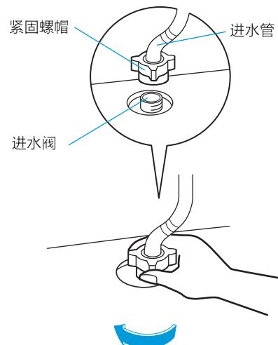
注：安装完毕后，请打开水龙头，检查是否漏水。
