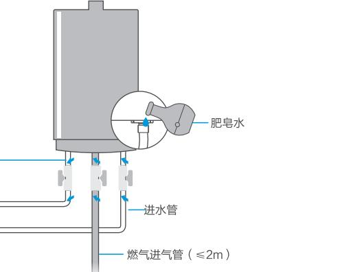
经常（一般半年左右）检查供气管道（橡胶软管）是否完好，有无老化、裂纹。注意定期更换橡胶软管，请经常用肥皂水在管路接口处检查有无气泡出现，判断是否漏气，若有漏气现象应立即解决。
