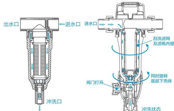
说明：打开排水旋钮，原水由进水口进入过滤器，冲刷钢网外表面，由排污口带走杂质。（QZBW20S-12可通过旋转底部下壳体进行刮洗排污）
