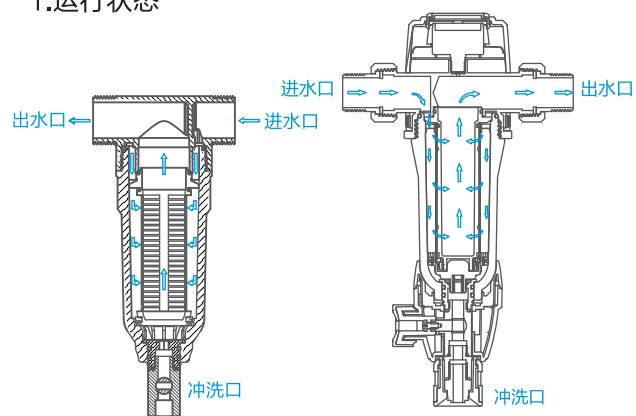
说明：原水由进水口进入过滤器，经过钢丝网内芯时，大颗粒杂质被拦截在钢网外表面，过滤后的水由出水口到后级水管。
