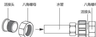
步骤四：将配件包里的2个密封垫装入已装好的八角螺母内（放入即可），而后将大铜体与八角螺母连接并用扳手拧紧。
