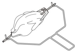
7 先将**烤轴尖头**一端插入腔体**右侧孔位**, 再将**方头**一端搭在腔体**左侧凹槽内**
