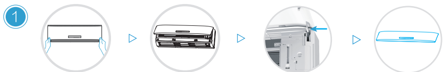
抓住面板两端稍用力向外拉， 打开约75度角
