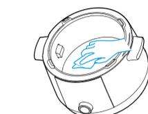
4 发热盘表面的油污，可以使用湿布清理，禁止直接倒入水和清洁剂擦洗。注意：必须首先断电，等产品完全冷却后进行，小心烫伤。
