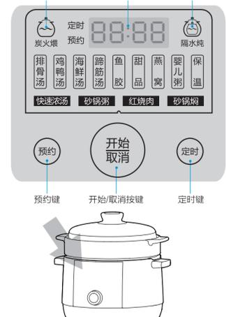
注：炭火煨采用类似炭火的红外辐射加热方式。
