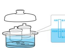
根据钢胆的水位线指示放入清水。注：水量不能超过“放置前”的“最大”刻度，防止溢出；水量低于“最小”刻度，可能出现干烧或食物烹饪不熟。依次放入炖芯隔板、炖芯，盖上陶釜盖。
