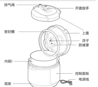
排气阀 开盖提手 密封圈 上盖 浮子 防堵罩 内锅1 控制面板 电源线 底座 内锅2
