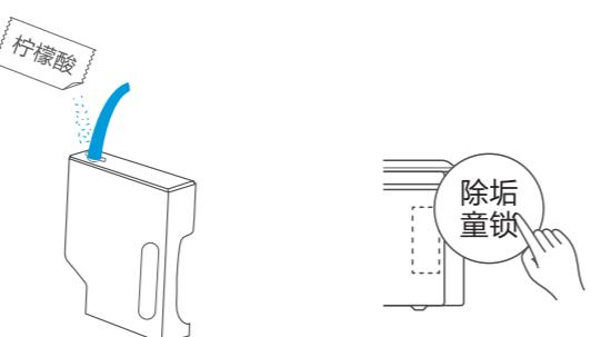
1. 取出净水盒，加入除垢剂（柠檬酸），并按调配比例说明加入相应的水，混合均匀。除垢剂混合液不得低于水盒刻度线
