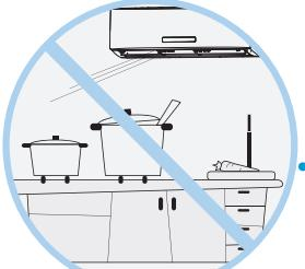
**切勿在空调风直接吹到的地方使用燃烧器具**
