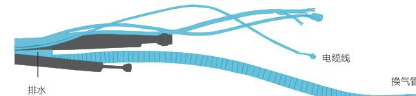
1. 将连接管理直平铺在地板上 - 将排水管、换气管、各种电缆线（必须将两端的插接端口整理正确）铺在连接管周围。
