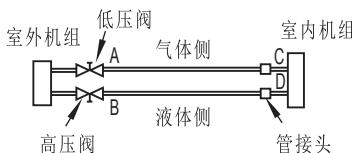
方法一：用室外机中制冷剂排除空气（首次安装时用）
