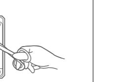
2. 卸下出风罩，垂直向右取下出风海帕，海帕可用水轻轻清洗，不可蛮力搓洗，并充分晾干后，按照以上拆卸步骤装回。
