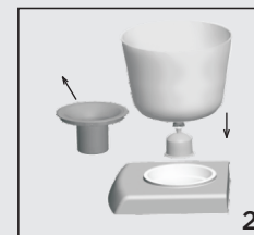
2、旋开饮水机的聪明座，再将下桶插入到饮水机分水池内。
