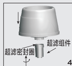
4、将超滤组件轻轻旋进上桶下部的卡位中。(注意：安装时请保证超滤密封圈不被挤出，否则会导致漏水。)
