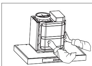
3 ) 拆下机架盖板上的螺钉，
