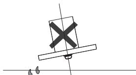
■ 吸油烟机安装后，应保持左右水平。
