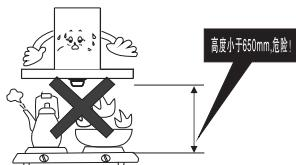
■ 理想的安装位置：吸油烟机安装于灶具正上方，机体底端到灶面的距离为650mm~750mm。
