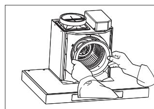
4 ) 拆下蜗壳上固定进风圈的螺
