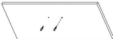
3) 用自攻螺钉将挂板固定在墙壁上。
