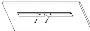
3) 按标识接好电源线，注意必须连接地线，且保证接地可靠，确定无误后将灯体固定在墙壁上，通电试灯，完成安装。
