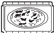
烤制肉类、披萨等油脂类较多的食物，需使用烤盘 烤盘放在烤架上
