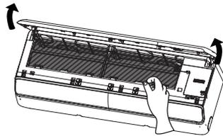
将滤尘网清洗干净，放置在阴凉处晾干
