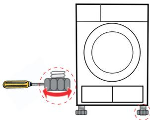
注意：调节底脚使用的工具请选择直径小于4.5mm的螺丝刀。
