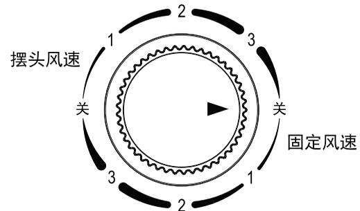
1. 插上电源前请确保旋钮开关处于[关]的位置。
