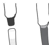
备注：对接排水管时，排水管在外层，套入室内机排水管，用力使两管接触面贴到尽头。
