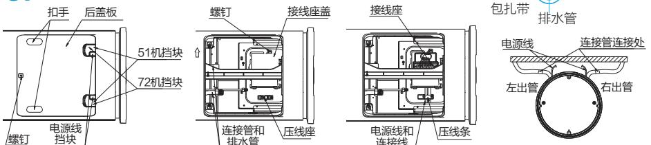
1. 将连接管理直平铺在地板上—将排水管、各种电缆线（必须将两端的插接端口整理正确）铺在连接管周围。
