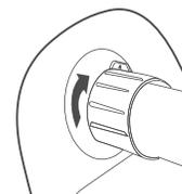
a 将导气管固定件对准热锅出汽孔接口，插到底
