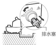
4、产品上的水垢及表面灰尘, 请使用毛巾吸取10%白醋与90%水混合液进行反复擦拭; 当蒸汽减弱时, 请用10%白醋与90%水混合液, 从蒸汽口注入, 等待40分钟后, 将水排出; 把混合液换成清水, 按以上步骤重复操作几次, 达到清除水垢效果。每次使用完冷却约30min后定期排水可延长产品寿命。
