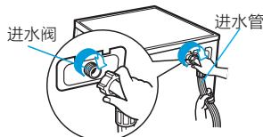
**注:** 安装完毕后,打开水龙头, 检查是否漏水。
