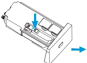
1.按[ $\text{D}\text{O}\text{W}\text{N}$  OPEN]键，洗涤剂盒自动缓慢弹出，按压A处卡扣，可将洗涤剂盒全部取出
