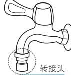
**注:** 不要在洗衣机专用水龙头的转接头上安装连接座。如果用户已有洗衣机专用水龙头,为防止脱落漏水,请拧下转接头后,再将进水管连接座的螺钉固定安装在水龙头螺纹上方。
