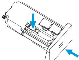
4.将洗涤剂盖，柔软剂盖复原，把抽屉推回到位
