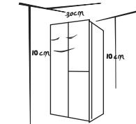
冰箱顶部空间大于30cm，两侧及背部与墙的距离大于10cm，便于冰箱门的开合和热量散发，用温湿抹布将冰箱内外擦干净（温水中可加少量洗涤剂，最后用清水擦净）。
