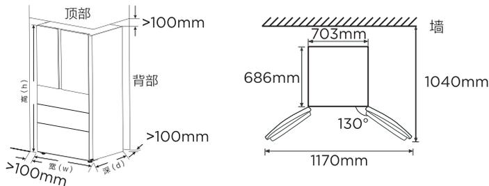
a: 为保证冰箱散热,冰箱顶部、两侧、背部空隙均需大于100mm。
