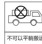
**△注意**在移动或搬运冰箱如调整摆放位置、搬家时,需提前取出冰箱内所有食品,用胶带将玻璃搁架等易移动的配件固定好,关紧并用胶带固定冰箱门,搬运过程中,底角翘起角度不可大于45°,也不可以平躺搬运。
