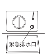
2.向左或向右旋转90° 拉出紧急排水管,拔下紧急排水导管盖
