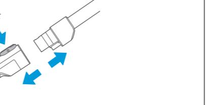
2. 按下按键，同时向上旋转侧盖；将侧盖与滚刷一起取出，对滚刷进行清洁，清洁完毕后与拆卸步骤相反装回。
