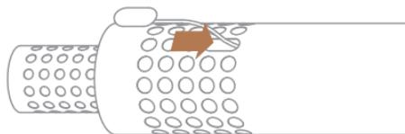
3. 在烟管安装到整机前，先将温度探头连接线与整机进风口预留的接头对接。
