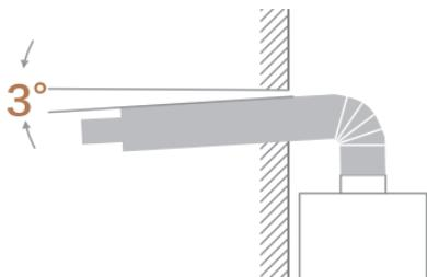
壁挂炉的烟管必须连接到室外，如果没有安装烟管，禁止启动壁挂炉；烟管的排气出口处与周围的距离如下图所示。
