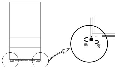
方法：冰箱共计2个调平脚，顺时针旋转调平脚，冰箱升高；逆时针旋转调平脚，冰箱降低。
