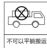
△注意 在移动或搬运冰箱如调整摆放位置、搬家时，需提前取出冰箱内所有食品，用胶带将玻璃搁架等易移动的配件固定好，关紧并用胶带固定冰箱门，搬运过程中，底角翘起角度不可大于45°，也不可以平躺搬运。
