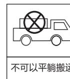
**注意** 在移动或搬运冰箱如调整摆放位置、搬家时,需提前取出冰箱内所有食品,用胶带将玻璃搁架等易移动的配件固定好,关紧并用胶带固定冰箱门,搬运过程中,底部翘起角度不可大于45°,也不可以平躺搬运。
