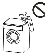
干衣机工作时，不要靠近干衣机使用可燃性喷雾剂，当煤气、易燃气体泄漏时，不要插拔电源插片及开关机。
