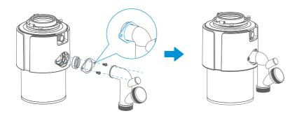
第二步:排水口敲击前准备(此排水口一旦敲通后就必须使用,如不需要安装可直接跳过后面三道排水口安装步骤,请谨慎安装。) 将主机放倒用钝角螺丝刀或工具放入排水口内,完成后进入下一步洗碗机排水口敲击。
