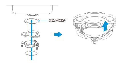
第六步:紧固进口器将上紧扣上面的三颗法兰螺丝拧紧,确保三颗法兰螺丝拧紧长度大致等同即可,完成后进入下一步安装四通排水管。
