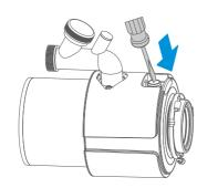
第三步:洗碗机排水口敲击用锤子敲击螺丝刀直至排水口敲通取出残料即可,完成后进入下一步安装排水管。
