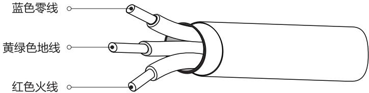
安装前检查家庭电路规格：检查电线规格必须是 $\geq 1.5\text{mm}^2$ 的铜芯线，必须选用16A的插头、插座，空气开关规格选择 $\geq 16\text{A}$ 。
