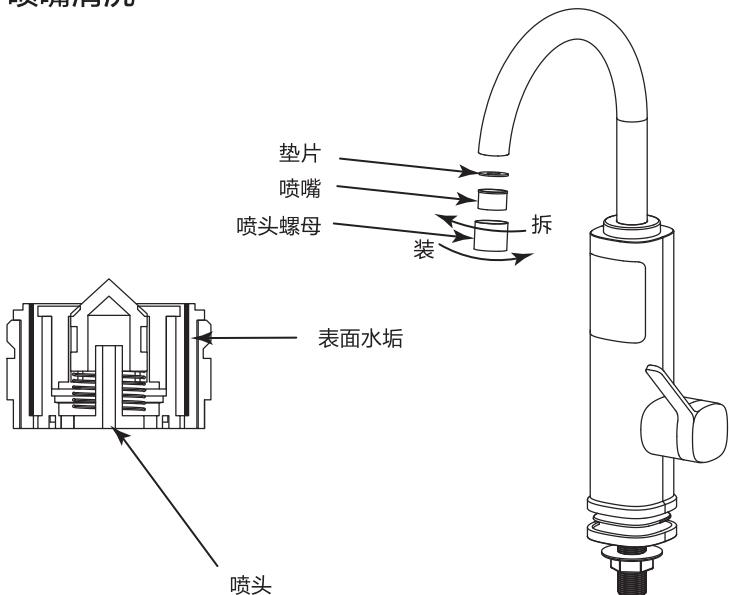
向左旋下喷头，用棉签擦拭喷头内部。清洗完毕后将喷头对准机身喷头孔，向右旋紧清洗完成。
