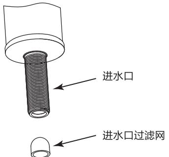
拆下后过滤网后用水清洗，之后按照原样装回。
