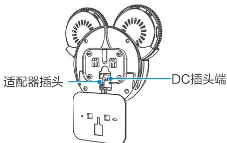
2、将适配器插头插入DC插头端,然后再将固定板扣好。
