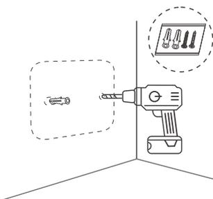
3、用专业电钻工具在墙体上钻孔 $\varnothing 5\text{mm}\times 25\text{mm}$ ,钻孔距离参考固定板的孔距,将膨胀胶塞塞进孔内。
