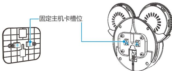
5、将固定板固定好后,然后按图中的A卡槽插入B卡槽中即可。
