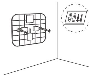
4、将固定板上的螺丝孔洞,对准墙面孔洞,用螺丝固定上紧。
