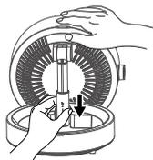
2: 右手扶稳产品，用左手将套筒向下按压至锁定处即可固定。
