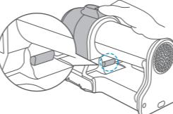
3. 杀菌吸口处于常闭状态,如图安装毛刷接管和毛刷(此时杀菌吸口被锁住无法打开),可进行局部小面积清洁。
