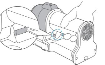
2. 需要收回可旋转吸口时,直接将吸口向内旋转即可。
