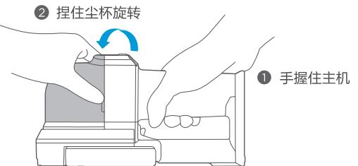
2. 取下尘杯，拆下尘杯过滤架，将尘杯中的灰尘倒入垃圾桶内；
