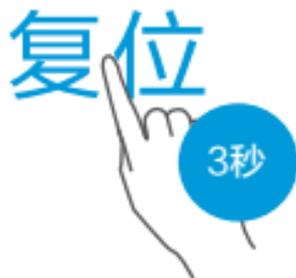
更换滤芯后，重新通水通电，长按复位键3秒进行复位，重新记录滤芯使用寿命。
