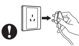
洗衣结束后，请拔出电源插头，拔出时勿拉扯电源线
