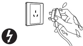
请勿用湿手插拔电源线插头，以防触电
