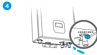
拧开安全阀排水，排完水后，装好安全阀即可。
