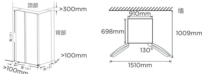
a: 为保证冰箱散热，冰箱顶部空隙需大于300mm，两侧、背部空隙需大于100mm。
