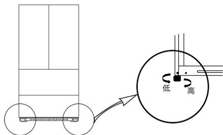
方法:冰箱共计2个调平脚,顺时针旋转调平脚,冰箱升高;逆时针旋转调平脚,冰箱降低。
