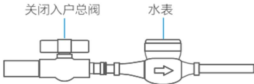
关闭入户管道阀门，放空管道内残留自来水，确保铜阀头与滤瓶拧紧。
