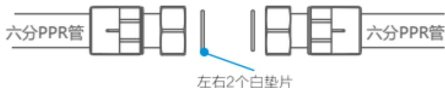
用热熔器将随机附带的2个活接头分别与管路熔接。
